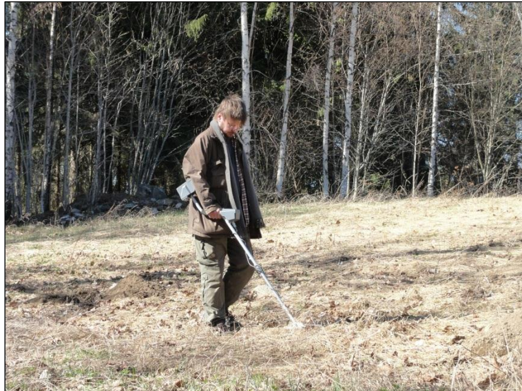
T Sepänmaa tutkii kaapelilinjaa metallinpaljastimella.
